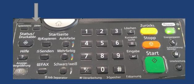
1. die Taste "Zähler", links unter dem Display, betätigen und der Zähler wird angezeigt Alternativ kann der Zähler unten links in der Zähleranzeige, über "Statusseite drucken" gedruckt werden.
