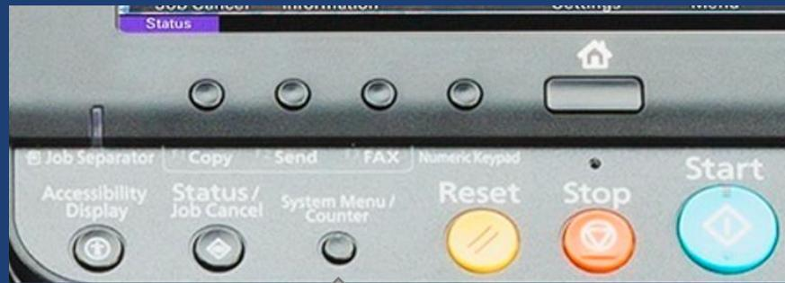
1. die Taste „Zähler“, mittig links unter dem Display, betätigen und der Zähler wird angezeigt
